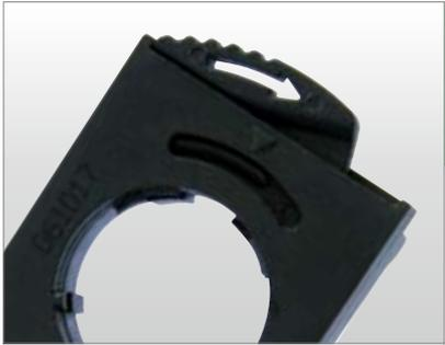
全新的自锁联接方式，安装拆卸更加方便，无需任何工具。（安装时只需将连接支架上的三角箭头对准钮头上的三角箭头轻轻推入即可，拆卸时只需用手指拨动支架上方的缩紧开关即可将整个触点模块卸下）
